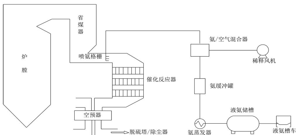
图 2 典型 SCR 脱硝系统工艺流程示意图
