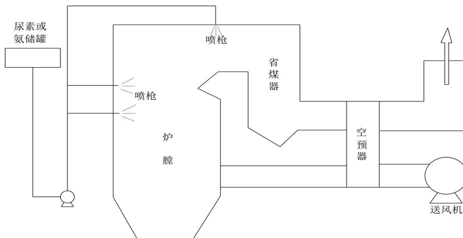
图 1 SNCR 工艺流程示意图
