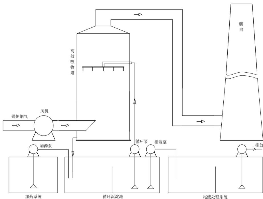
图 3 化学吸收工艺流程示意图
