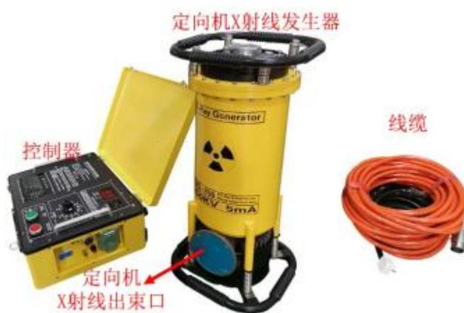
**图 9-1 X 射线探伤机外形及结构示意图**
