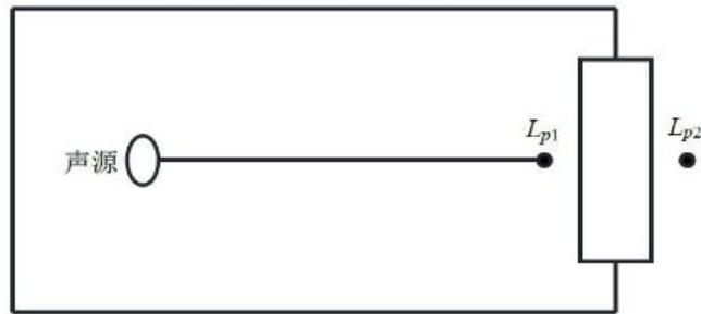
图 4-1 室内声源等效为室外声源图例
