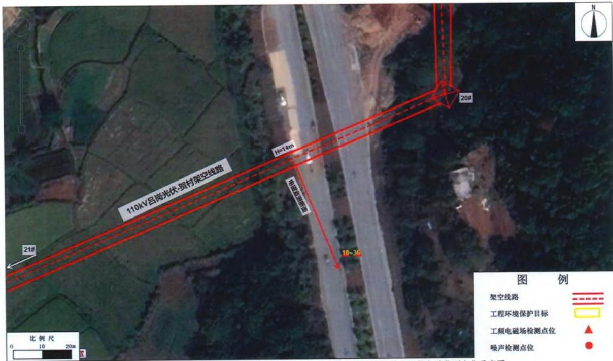
图 6.1-5 110kV 吕岗光伏-贺村单回架空线路类比监测布点示意图
