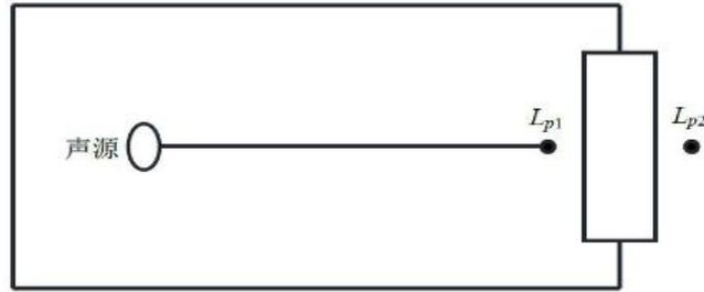
图 4-3 室内声源等效为室外声源图例
