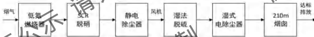
图 3.4.2-1 锅炉烟气治理工艺流程
