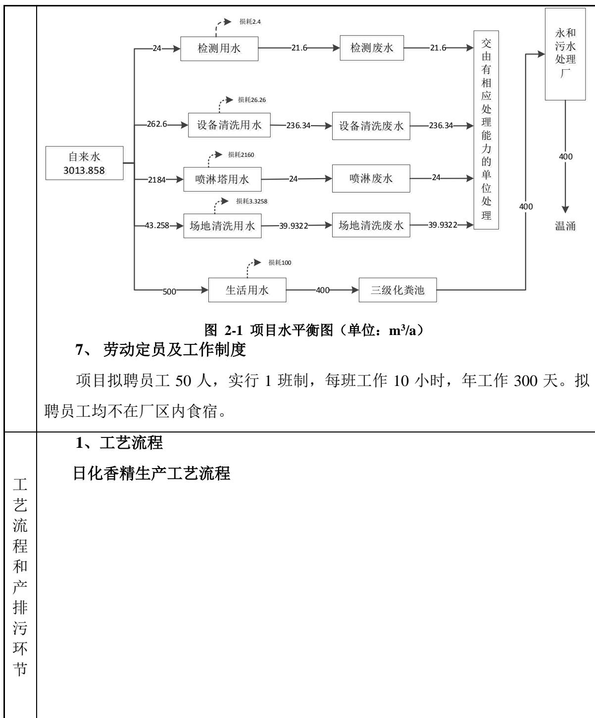
图 2-1 项目水平衡图 (单位:  $m^3/a$ )
