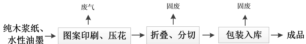
图2-14 纸巾生产工艺流程图
