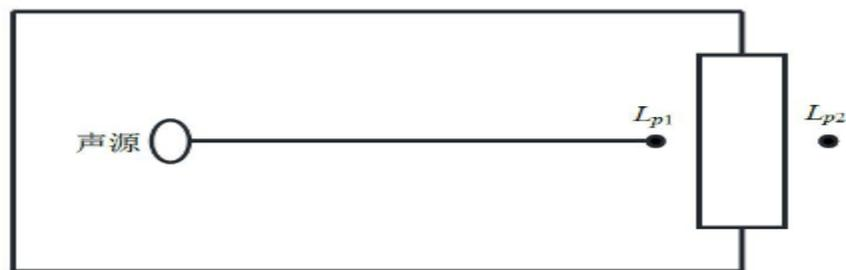
图 4-3 室内声源等效为室外声源图例
