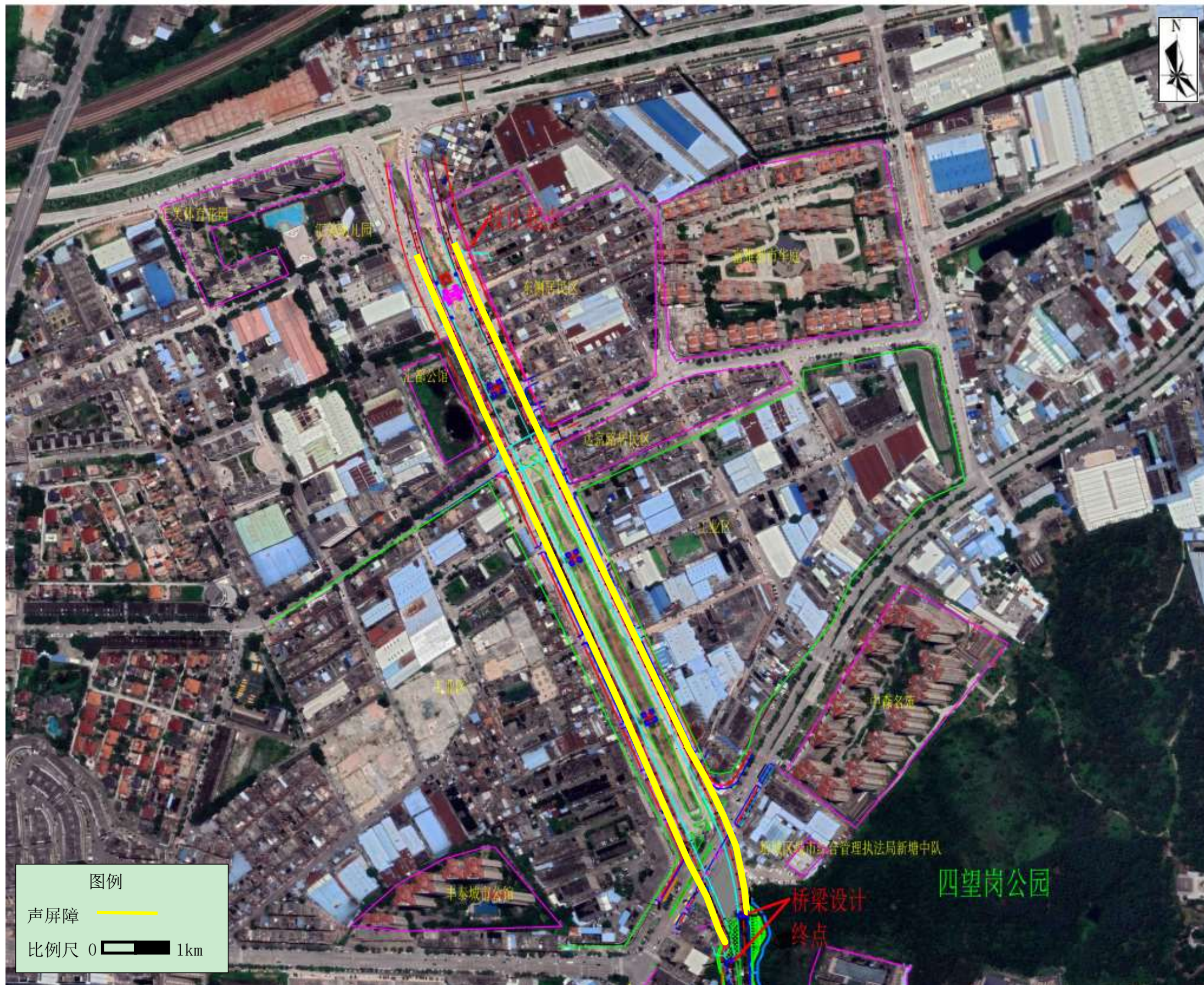
图 4.3-8 总声屏障设置示意图
