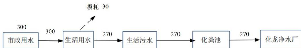
图 2-1 项目水平衡图（单位：m<sup>3</sup>/a）
