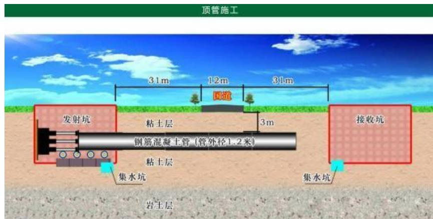
图 2-17 顶管施工工艺示意图
