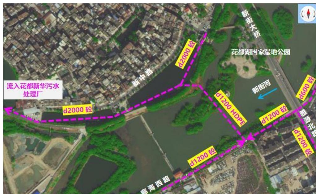
图 2-10 现状新街河过河污水管示意图（顶管穿越湿地公园）
