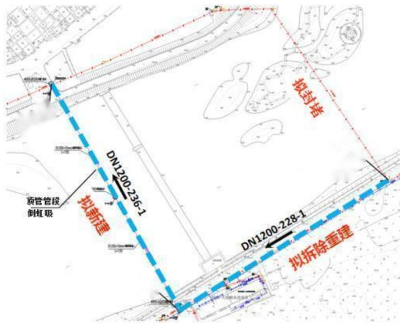
图 2-11 新街河新建过河管段改造示意图
