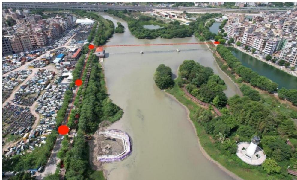
图 2-21 污水管道走向及各开挖面现场示意图
