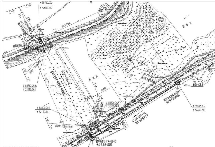
图2-7 管道穿越湿地公园示意图（比选方案1）
