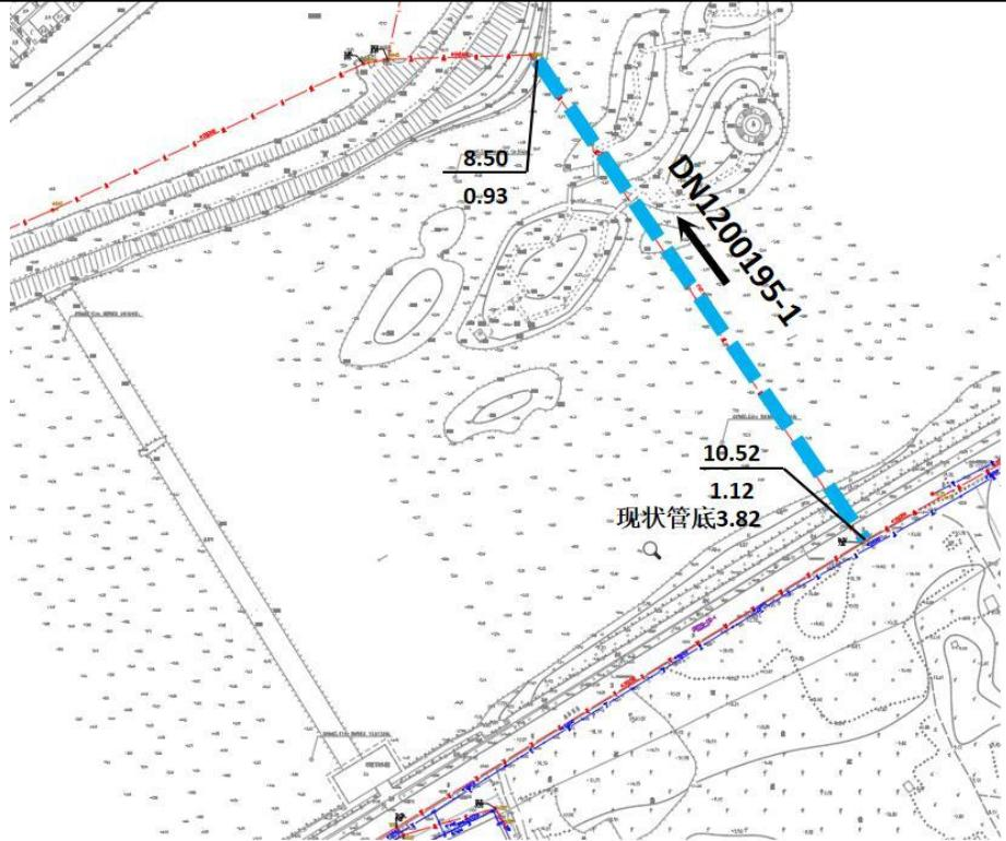
图 2-8 管道穿越湿地公园示意图（比选方案 2）
