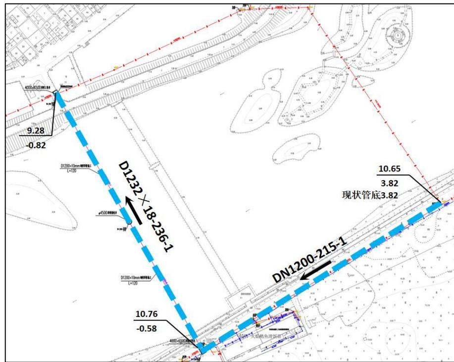
图2-6 管道穿越湿地公园示意图（方案一）
