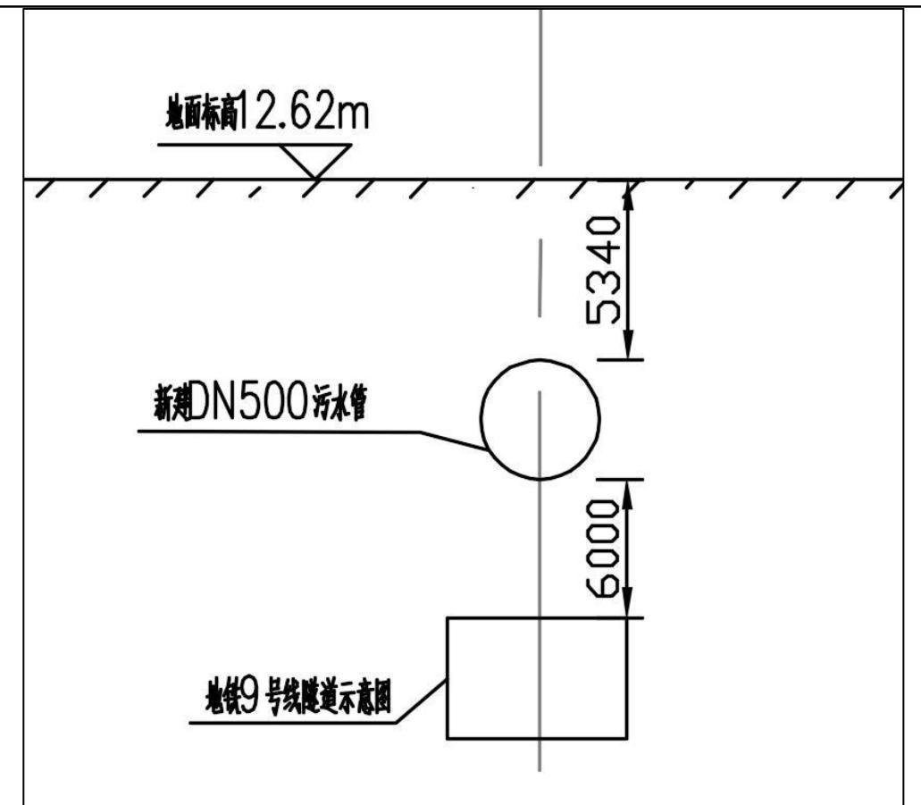
图 2-24 新建污水管道与地铁 9 号线的位置关系示意图
