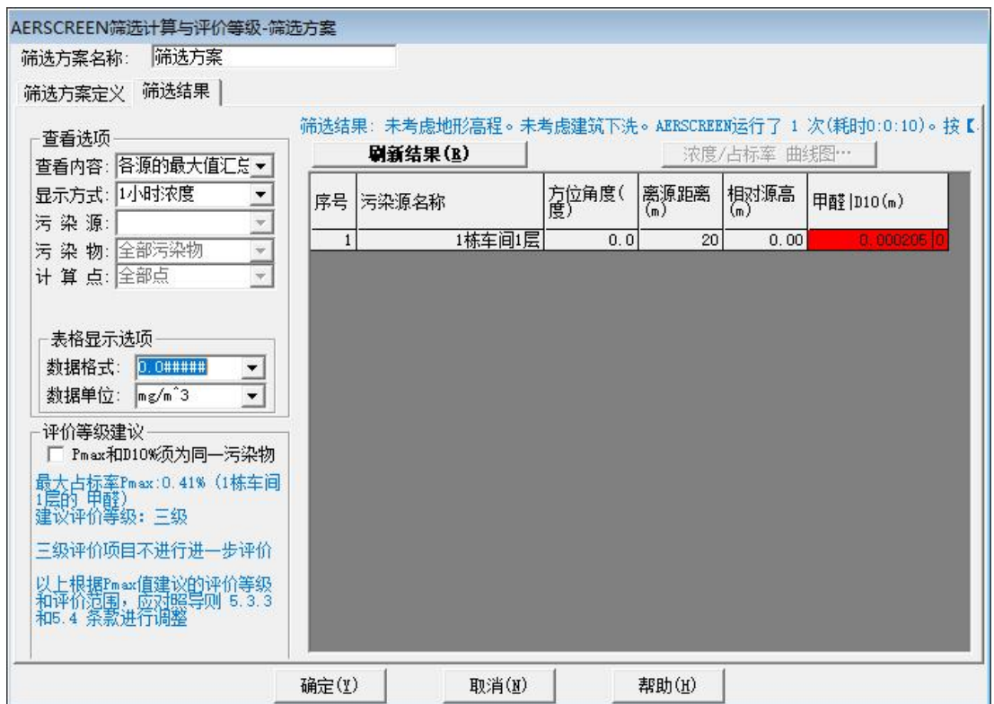
图 4-5 AERSCREEN 无组织预测 1h 最大落地浓度 (mg/m 3 )。
