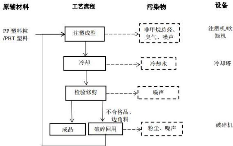
图 2-5 五厂（注塑件）工艺流程及产污环节图
