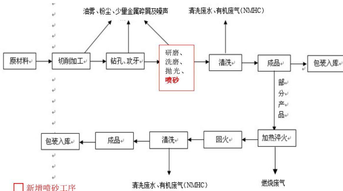
图 2-2 新豪公司汽车关键零部件总体生产工艺流程图
