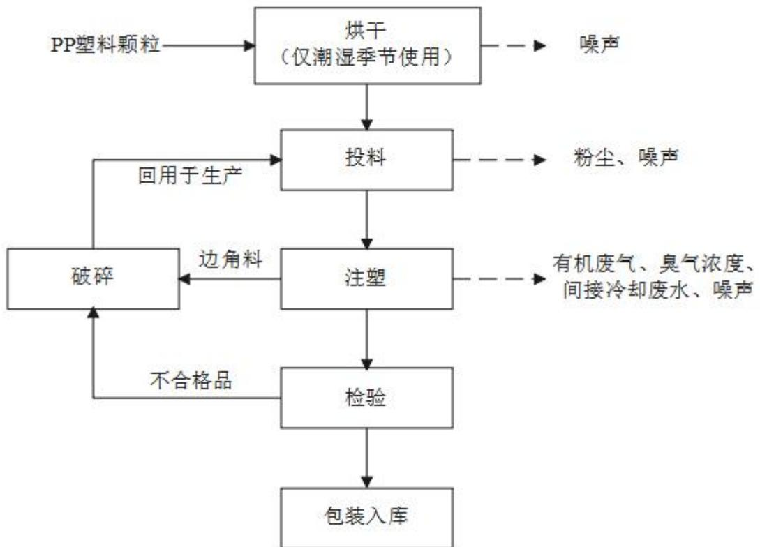
图 2-3 PP 内塞工艺流程及产污图
