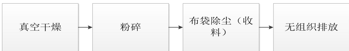
图 4-5 真空干燥粉碎工艺粉尘处理流程图
