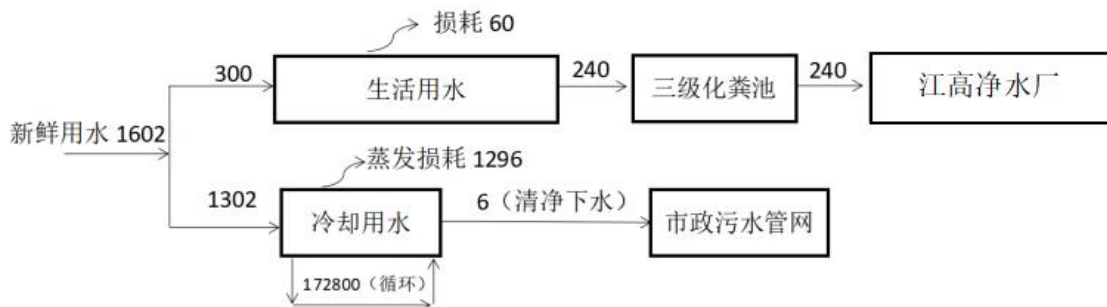
图 2-1 本项目水平衡图 (t/a)
