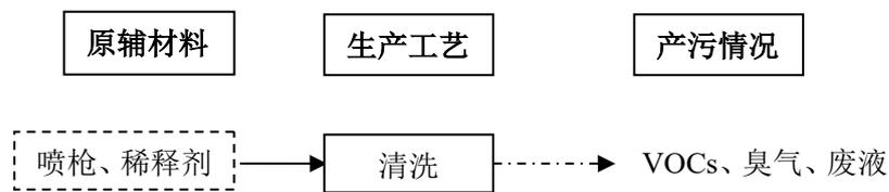
图 2-3 喷枪清洗工艺流程图
