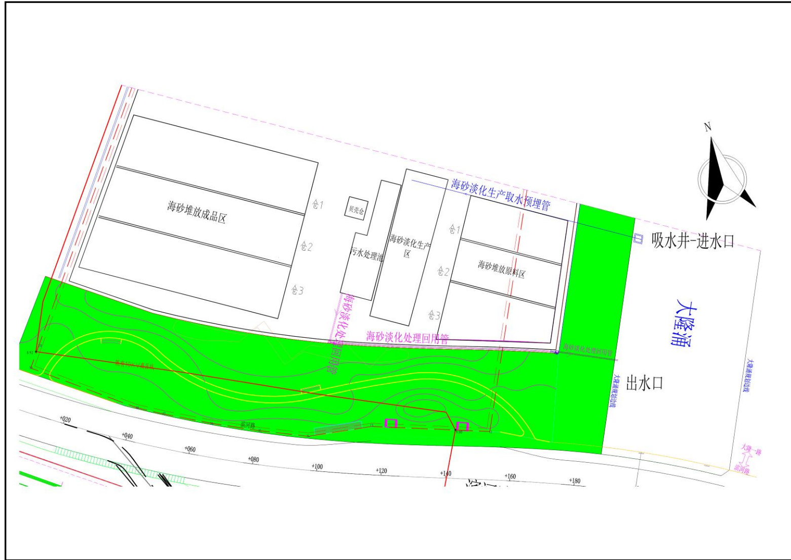
附图5 海砂淡化生产线总平面布置图 1: 1300
