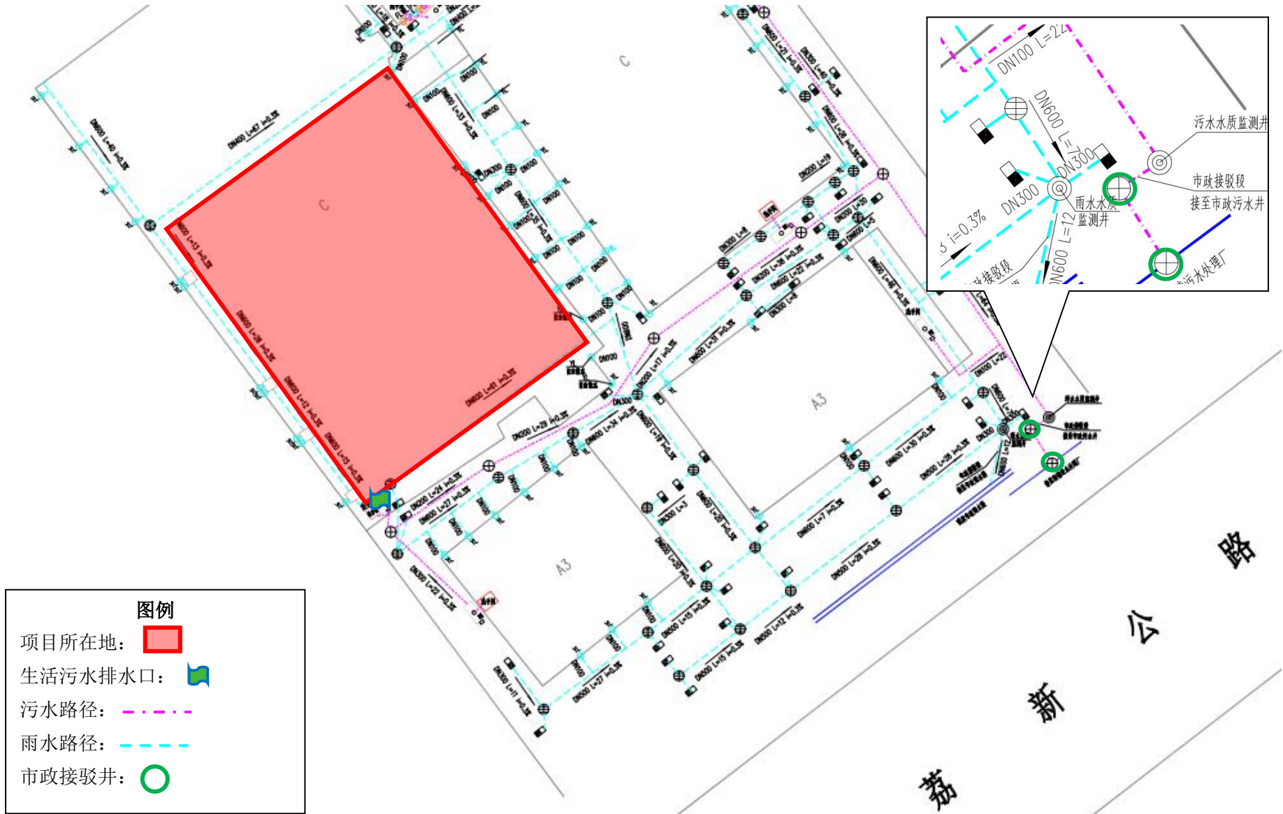
附图 3-3 厂区雨污管网图
