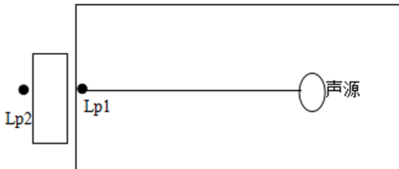
图 4-3 室内声源等效为室外声源图例
