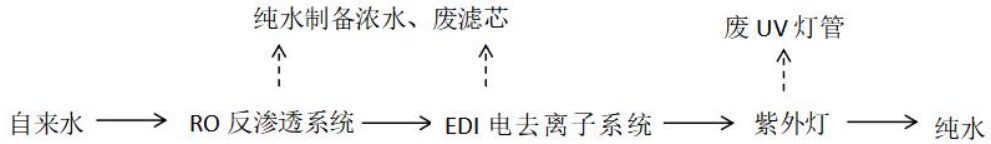
图 2-11 纯水制备工艺流程图
