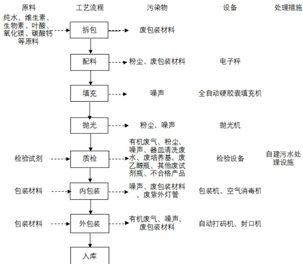
图 2-7 硬胶囊生产工艺流程及产污节点图
