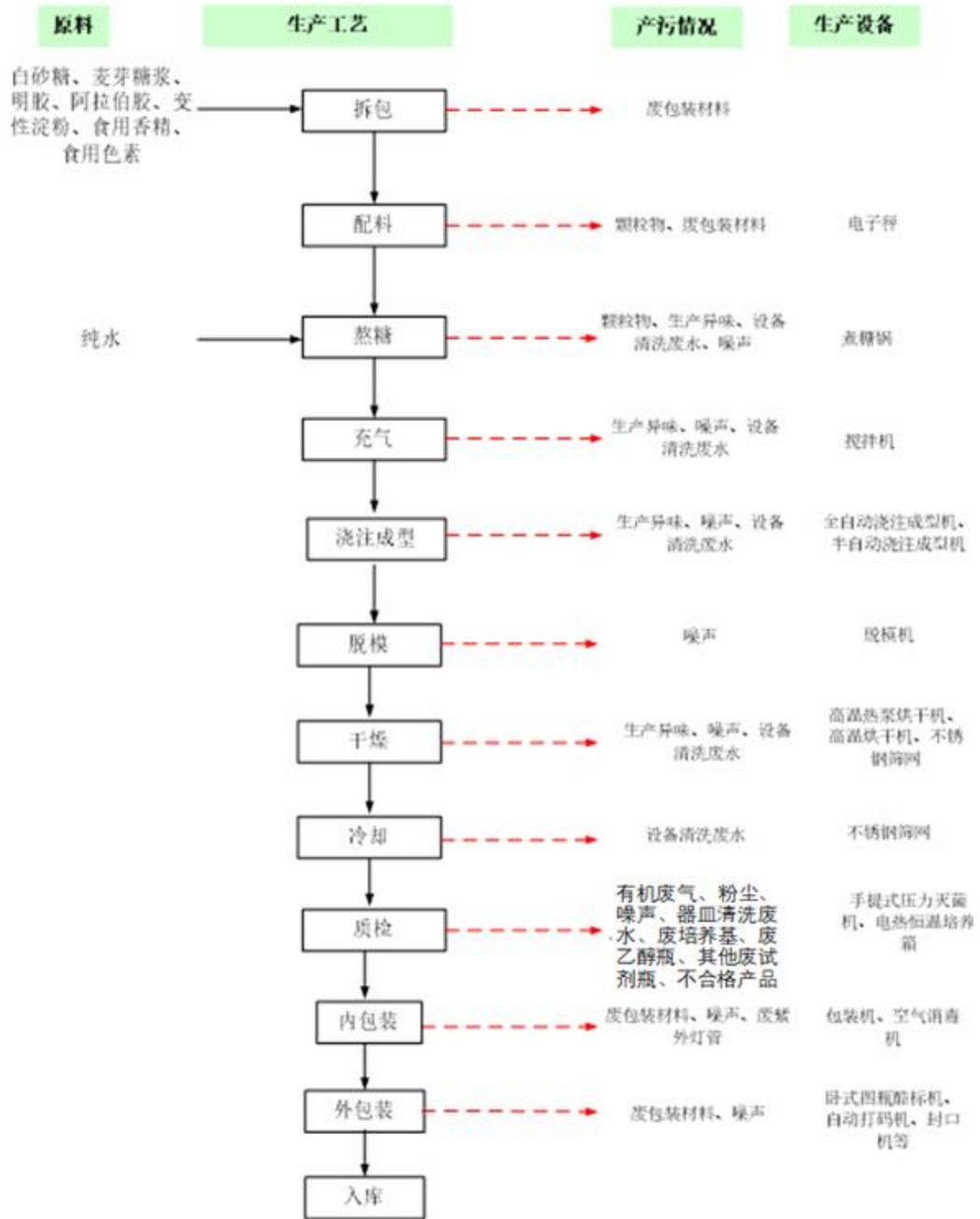
图 2-4 充气生产糖果工艺流程及产污节点图
