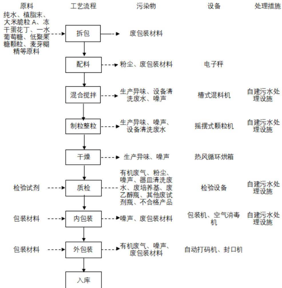
图 2-5 固体饮料生产工艺流程及产污节点图
