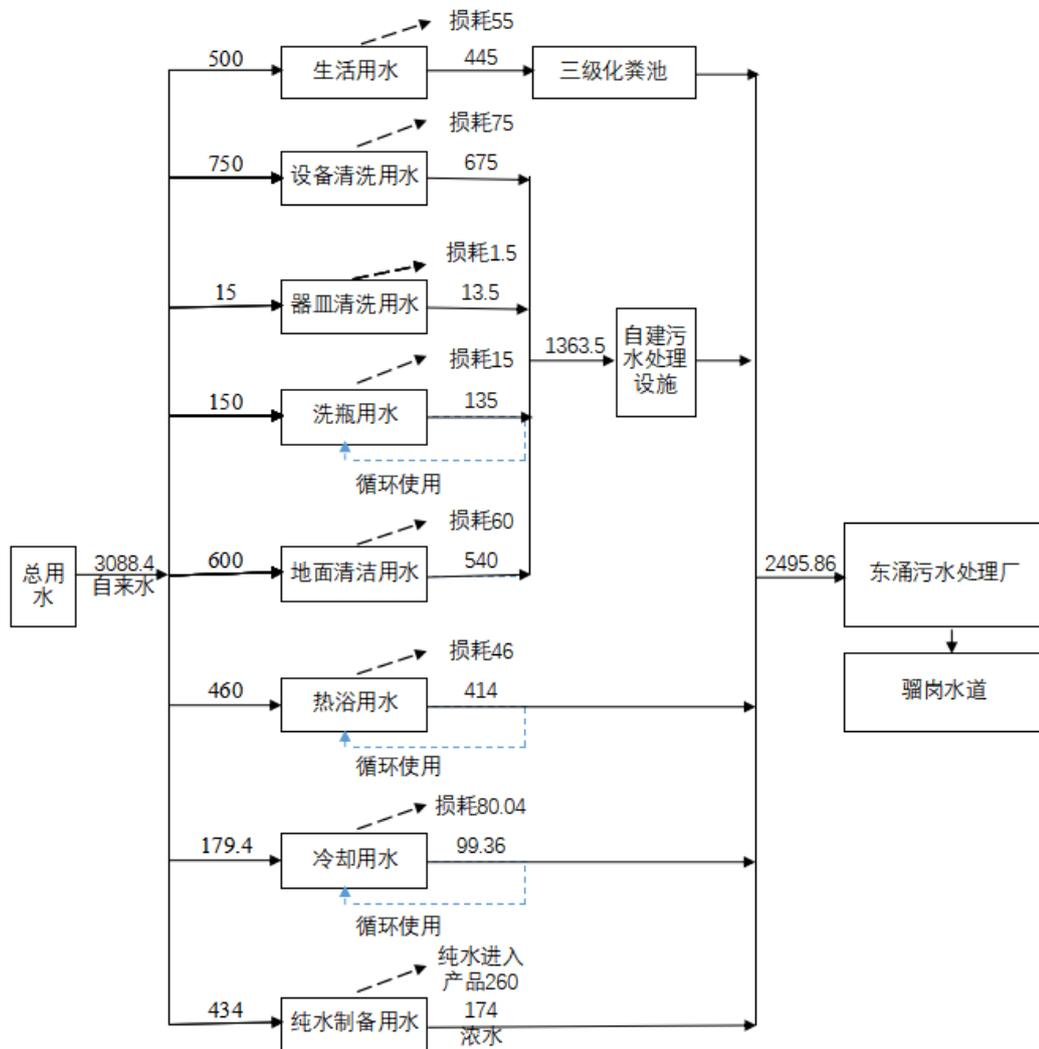
图 2-1 项目水平衡图 单位: m³/a
