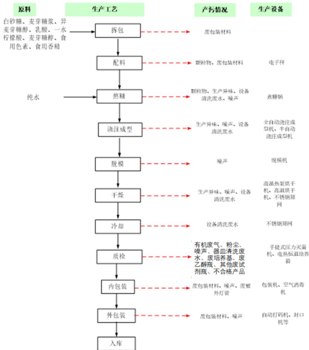
图 2-2 硬糖生产工艺流程及产污节点图
