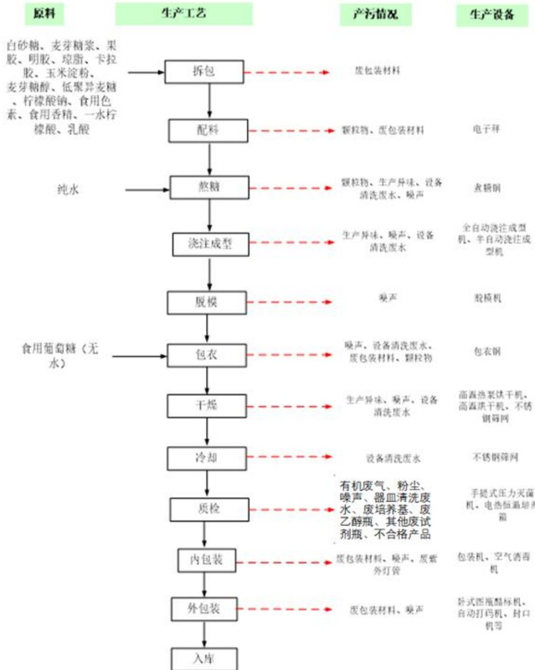
图 2-3 软糖生产工艺流程及产污节点图
