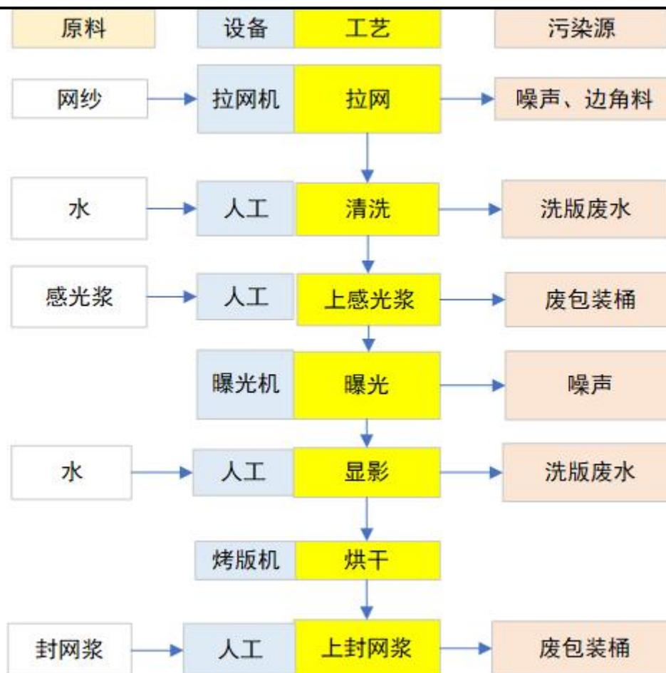
图 2-5 网版加工工艺流程图及产污环节
