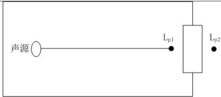
图 4-4 室内声源等效为室外声源图例
