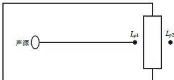
图 4-2 室内声源等效为室外声源图例
