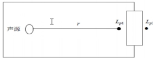
图 4-1 室内声源等效为室外声源图例
