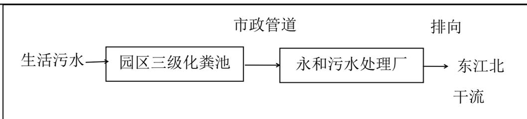
图 4-2 项目污水处理工程废水处理流程图
