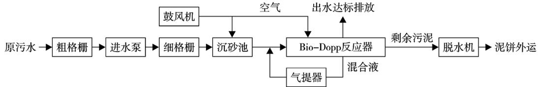
图 1 Bio-Dopp 工艺流程
