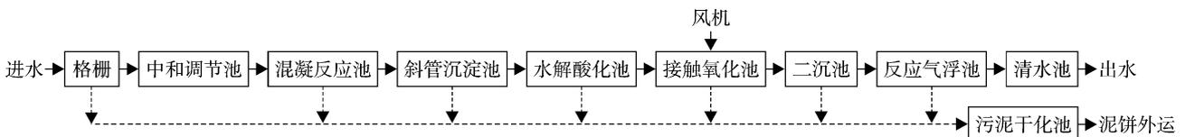
图 1 物化 + 生化处理废水工艺流程
