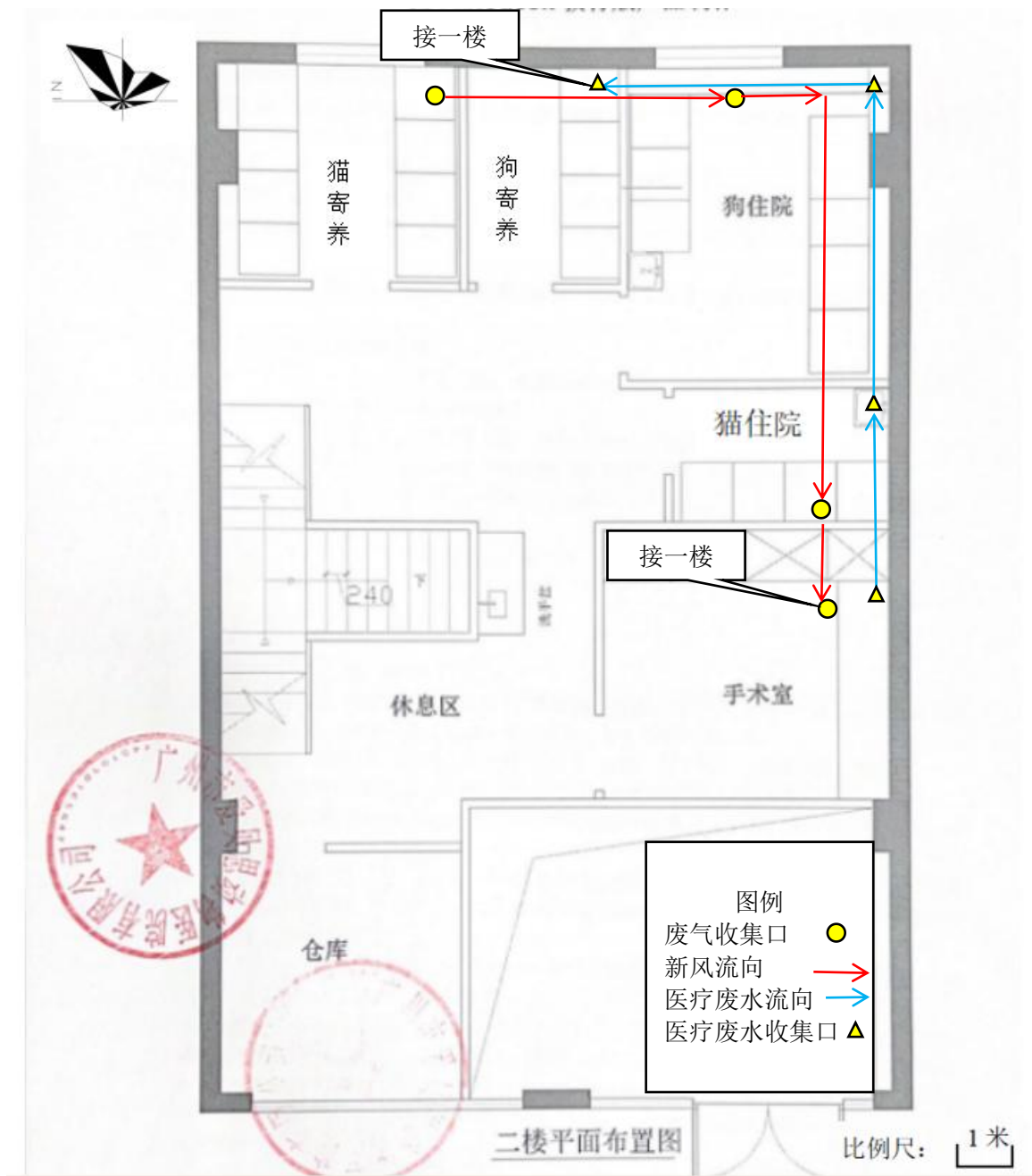
附图 2 项目平面布置、废气、废水收集管线及分区防渗图
