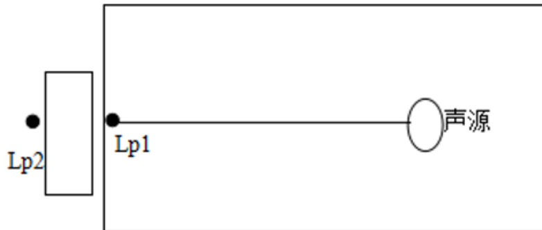
图 4-3 室内声源等效为室外声源图例
