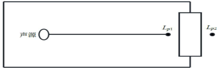
图 4-3 室内声源等效为室外声源图例
