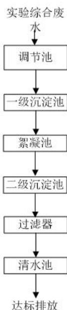
图 4-1 污水处理工艺流程图
