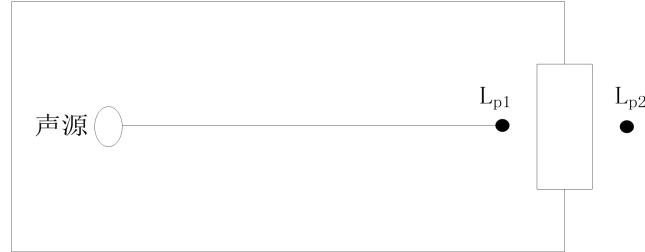
图 4-3 室内声源等效为室外声源图例
