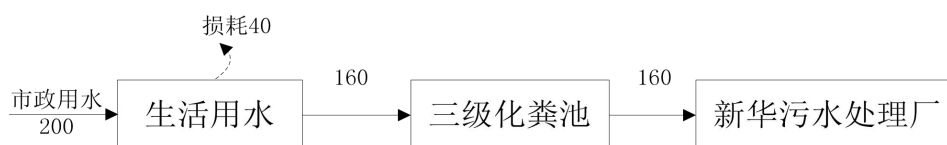
图 4-2 本项目年用水平衡图（单位：t/a）
