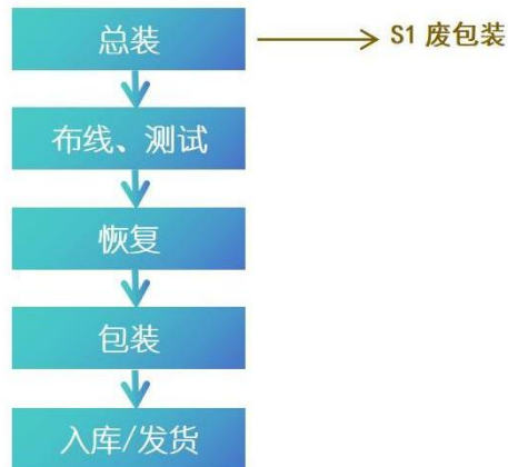
图 2-5 现有项目组装变流器工艺流程
