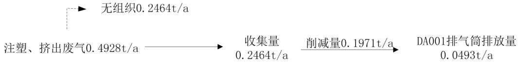
图4-1 VOCs平衡图
