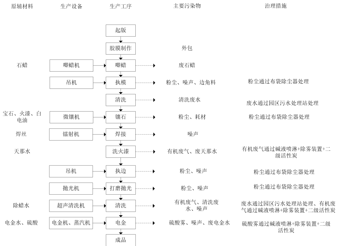
图 2-2 珠宝首饰加工工艺流程及产污环节
