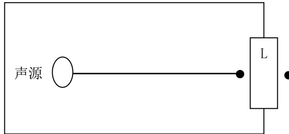
图 4-2 室内声源等效为室外声源图例
