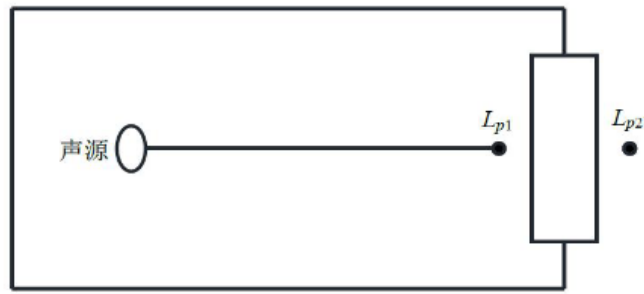
图 4-1 室内声源等效为室外声源图例
