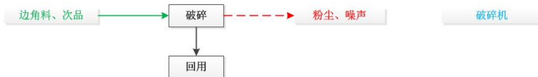
图 2-4 本项目破碎工艺流程及产污环节图
