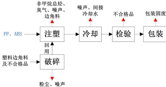
图 2-3 塑胶夹件生产工艺流程图及产污环节
