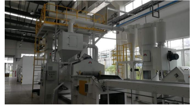
抛丸机及配套旋风水浴处理装置
