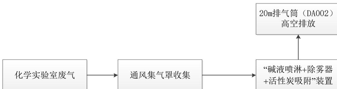
图 4-1 改扩建项目化学实验室废气处理工艺流程图
