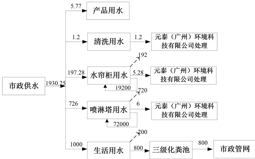
图 2-1 本项目水平衡图（单位：t/a）
