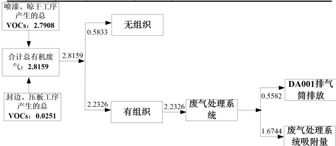
图 4-1 本项目总 VOCs 平衡图
