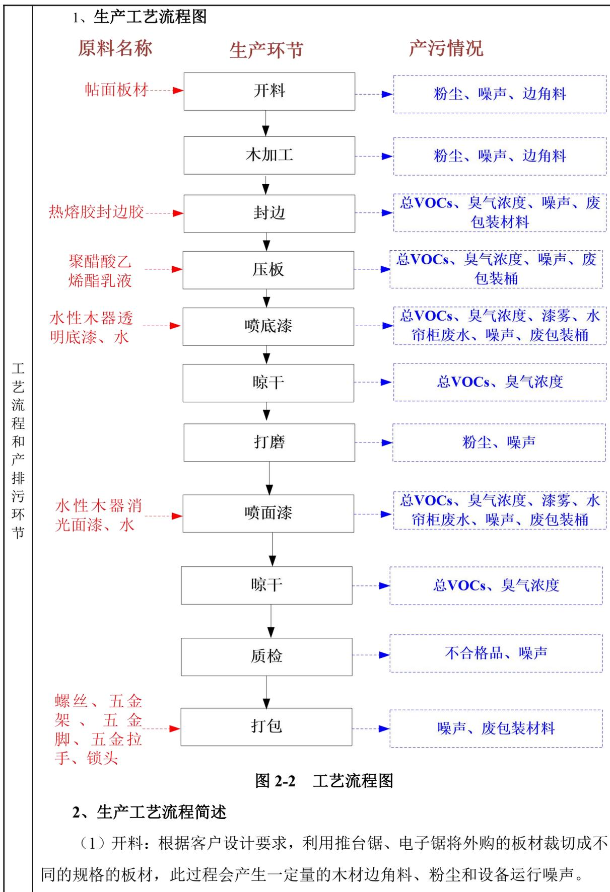
(2) 木加工：主要是对裁切好的板材进行钻孔、开槽、开榫等工作，此过程会产生一定量的木材边角料、粉尘和设备运行噪声。
