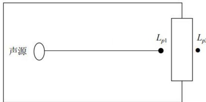
图 4-2 室内声源等效为室外声源图例
