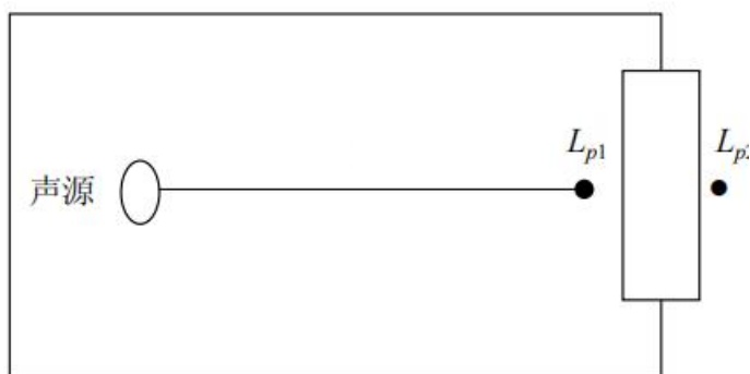
图 4-1 室内声源等效为室外声源图例
