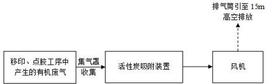
图 4-1 活性炭吸附装置处理工艺流程图
