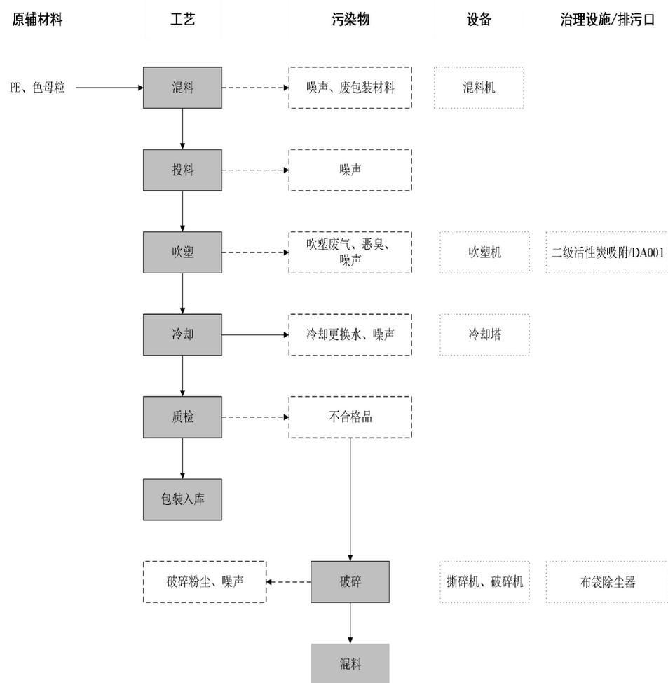
图 2-2 隔离水马生产工序流程和产污环节示意图
