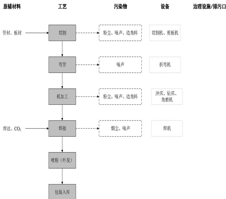
图 2-3 钢材护栏、铁马、钣金类产品生产工序流程和产污环节示意图
