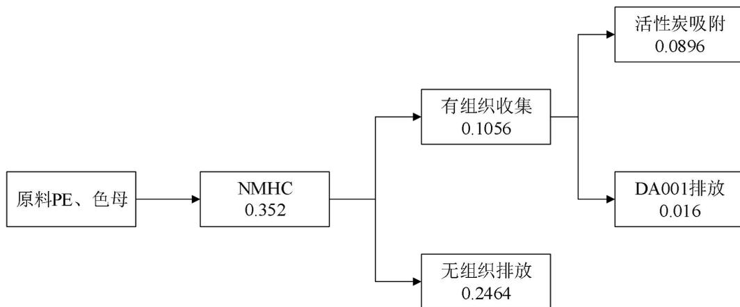
图 4-1 NMHC 平衡图 单位：t/a
