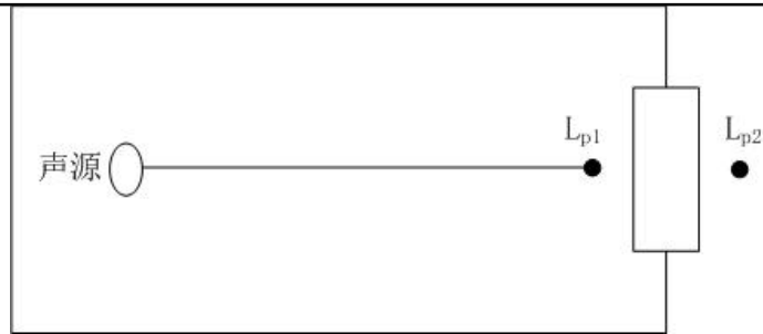
图 4-3 室内声源等效为室外声源图例
