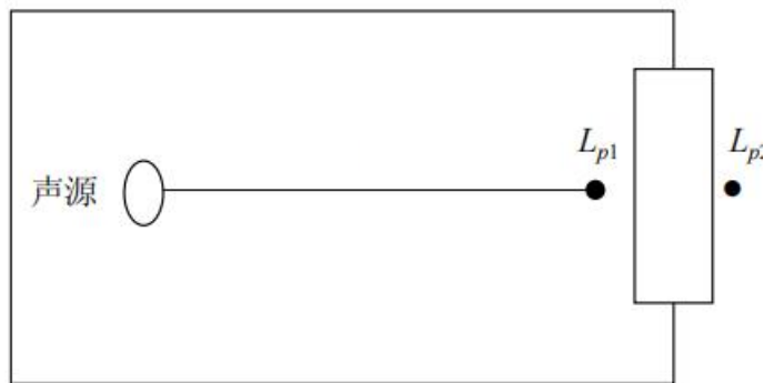
图 4-1 室内声源等效为室外声源图例
