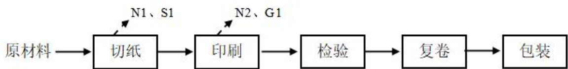
图 2-2 原项目生产工艺流程与产污环节示意图
